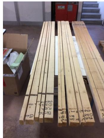
Tutti i provini ricavati, sono stati sottoposti ad un'ulteriore fase di stabilizzazione attraverso condizionamento nella medesima cella igro-statica di cui sopra (T: 20 +/- 2°C, umidità: 65 +/- 5 %).
